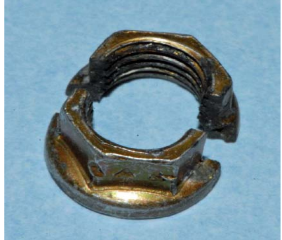
La figure 1 ci dessus illustre un écrou rompu qui s'était séparé en deux trouvé par un exploitant.
